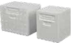
Inserto rígido de EPS moldeado de alta densidad (170 kg/m³) con la función de soporte de montaje para cargas externas sin formación de puentes térmicos (aleros, persianas, cortinas, letreros...) Idóneo para EPS y lanas minerales.
