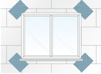
Aplicación de refuerzos diagonales, para todos los ángulos en aberturas, realizada mediante la aplicación de bandas netas de dimensiones de aproximadamente 20x40 inclinadas 45° con respecto al eje perpendicular de las mismas, para contrarrestar tensiones y evitar microlesiones superficiales.
