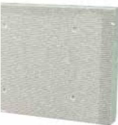
Panel termoaislante auto-extinguible en poliestireno expandido sinterizado hecho en Neopor®; gracias a sus partículas de grafito, tiene la capacidad de absorber y reflejar los infrarrojos, asegurando mayor poder aislante sin variar el espesor. Con moleteado de 5 mm de profundidad por ambos lados, para la mayor resistencia del sistema.
