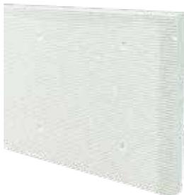
Panel termoaislante auto-extinguible en poliestireno expandido sinterizado. Idóneo para la realización de sistemas de aislamiento por capas (TermoK8® Bio Stone – Modular Big). Panel realizado con superficie externa moleteada y con rebajos para mejorar la adhesión y la unión mecánica.
