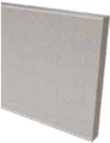
Placa aislante destensada, de conductividad térmica mejorada, realizada en poliestireno expandido sinterizado EPS con aditivo de grafito y moleteado de 5 mm de profundidad en la parte exterior. Con unas excelentes prestaciones térmicas con garantía de estabilidad dimensional: el proceso de producción controlado y expresamente estudiado permite obtener una superficie perfectamente plana y un encolado seguro incluso cuando se expone a las radiaciones solares más intensas.
