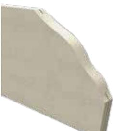
Panel termoaislante en poliestireno expandido sinterizado auto-extinguible con grafito, fresado por los cuatro lados con ranurado de 2 cm de profundidad y 2 mm de espesor. Idóneo para su fijación en los perfiles del sistema de aislamiento externo TermoK8® mecánico.
