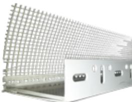
Perfil de arranque en PVC universal con goterón y malla a solapa. Dos piezas regulables para espesores de 10 a 20 cm.
