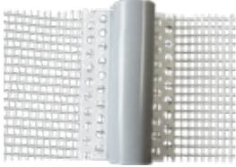
Junta de dilatación angular. Perfil de PVC pre acoplado con malla de fibra de vidrio (gramaje 145 gr/m<sup>2</sup>) para la protección del sistema en correspondencia con juntas angulares no superiores a 4/5 cm.
