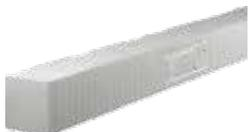
Inserto rígido de EPS con la función de soporte de montaje para cargas externas sin formación de puentes térmicos para sistemas EPS y de lana de roca. Sirve también como espesor de apoyo en caso de cargas intermedias.
