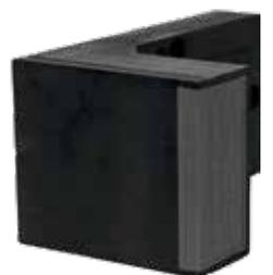
Elemento de montaje para bisagras y barandillas en espuma poliuretánica rígida, resistente a la putrefacción. Presenta una inserción de espuma inyectada en resina reforzada con fibra para garantizar un excelente atornillado a la superficie, una carcasa para pies de apoyo y un inserto de resina adicional para atornillar el componente.
