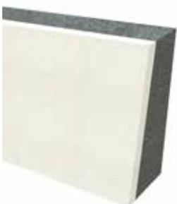
Panel termoaislante auto-extinguible en poliestireno expandido sinterizado EPS sin HBCD, mezclado con grafito, con una superficie en EPS blanco producida mediante sinterización- laminación. Asegura la homogeneidad de la masa de volumen, la estabilidad dimensional absoluta y la perfecta cuadratura de las placas. Con las superficie externa e interna moteadas para mejorar la adhesión y la unión mecánica con la capa de alisado.
