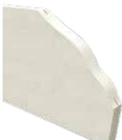
Panel termoaislante en poliestireno expandido sinterizado auto-extinguible, fresado por los cuatro lados con ranurado de 2 cm de profundidad y 2 mm de espesor. Idóneo para su fijación en los perfiles del sistema de aislamiento externo TermoK8® Mecánico.
