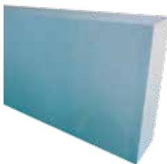
Placa aislante realizada en poliestireno expandido sinterizado EPS con aditivo de grafito; superficie en EPS azul producida mediante sinterización-laminación. Particularmente indicada para rodapiés en aplicaciones por capas. Ambas superficies planas presentan una textura especial que permite un excelente agarre y un encolado seguro.
