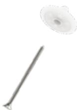
Taco roscado universal con tornillo de acero galvanizado para la fijación de paneles aislantes sobre soportes de madera y lámina (hasta 0,75 mm) para uso superficial o en penetración.
